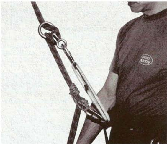
Fot. 2. Kontynentalny sposób zjazdu – wysoka ósemka, niski prusik
