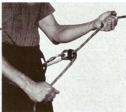
Fot. 6. Poprawny sposób trzymania liny w ręce hamującej
