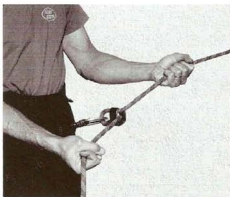
Fot. 5. Wadliwy sposób trzymania liny w ręce hamującej
