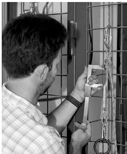
Pomiar odcinka wolnego końca liny, który wysunął się z węzła
